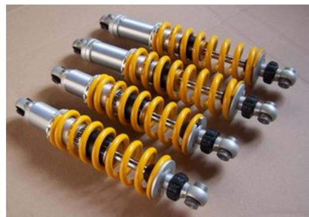
Ces amortisseurs sont réglables par une molette, qui agit conjointement sur la compression et la détente, alors que la pré-contrainte est quant à elle réglable par écrou et contre-écrou.
